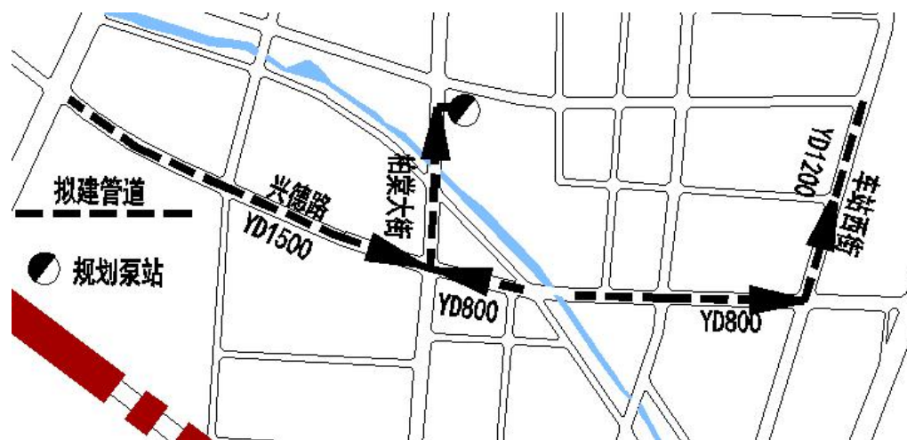
图12-8 兴德路（胜利大街-车站西街）雨污分流改造工程系统示意图
