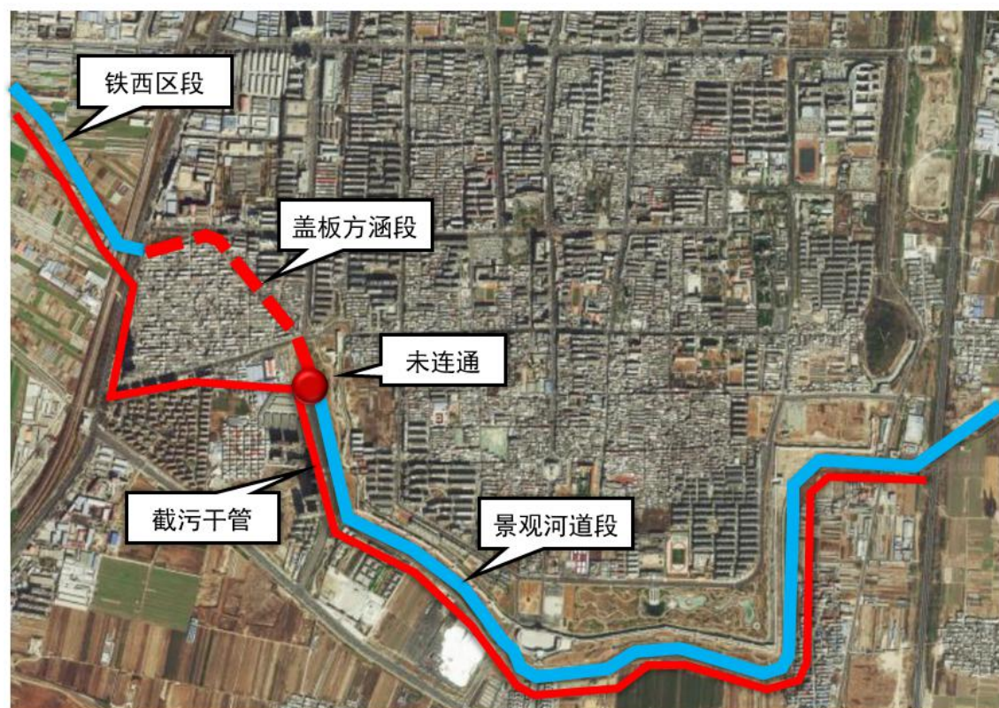
图9-3 周汉河盖板段与截污干管连通关系
